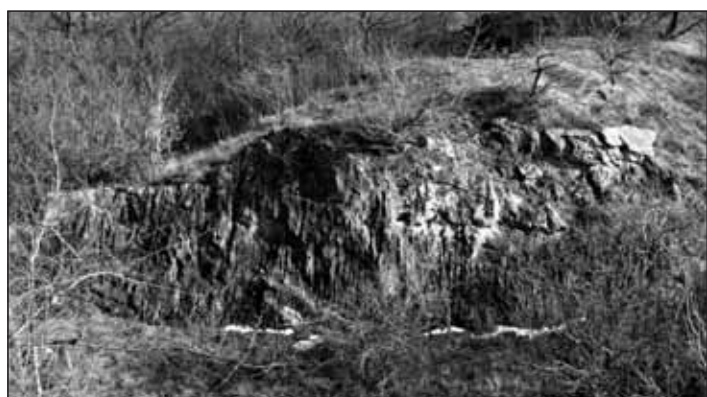
Obr. 9 Na stene sa dajú pozorovať stopy po jednotlivých odťažených blokoch. Svetlé horizontálne línie sú hranice blokov.
