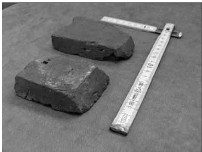
Obr. 20 Brno, domovní blok 39. Zakončení plochých střešních tašek podélným průřezem lb (zkosení hrany). 13. století. Muzeum města Brna bez i. č.
